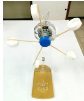
ใบพัดที่ทำจากฝาขวดน้ำพลาสติก
